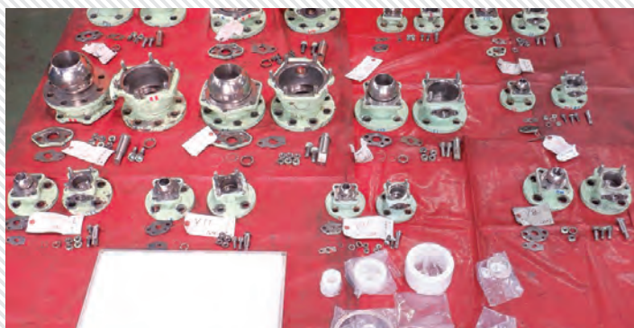
▶バルブ・安全弁分解整備
