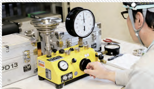
▶圧力計器差検査
