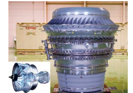
エアバスA350XWB用Trent XWBのIPCモジュール
