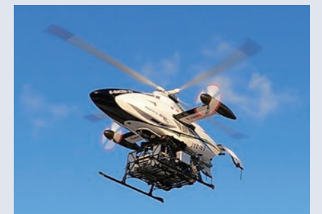
配送ロボットを積み込んだ無人VTOL機
