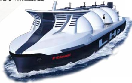
エネルギー用途の水素は大量に扱う必要があり、輸送段階では、いかに効率よく運ぶかがポイントとなります。液化水素は、水素ガスよりも体積が800分の1と極めてコンパクトなので、輸送・貯蔵の形態として、最も優れています。
