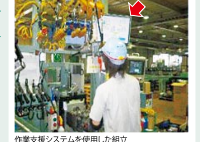
作業支援システムを使用した組立
