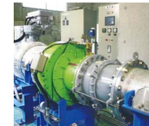
小川や農業用水路など小さな水の流いで発電できる小水力発電装置
