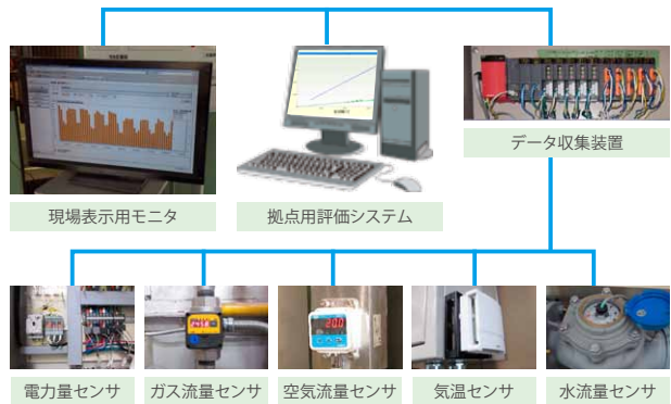
エネルギー見える化設備構成
