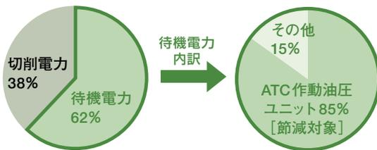
その対策として、ATC作動油圧ユニットのモータをインバータ制御化し、工具交換時のみモータ出力を定格まで上げ、それ以外の待機時間は最小限の出力での運転にようにしました。節減できた電力は3,653kWh/月となり、これは15t-CO<sub>2</sub>/年に相当します。
