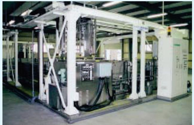
超音波フィルタ自動洗浄設備
