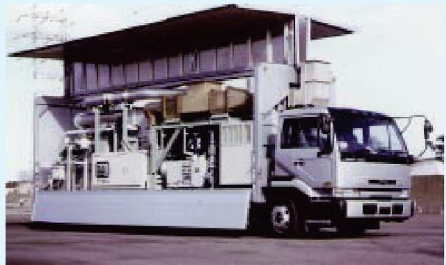
車載式下水汚泥乾燥設備
