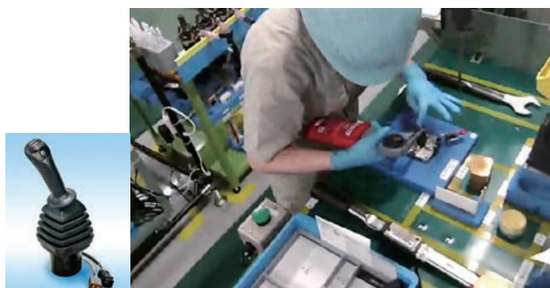
図1 電気ジョイスティックの組立 Fig.1 Assembly of Electric Remote Control Unit
