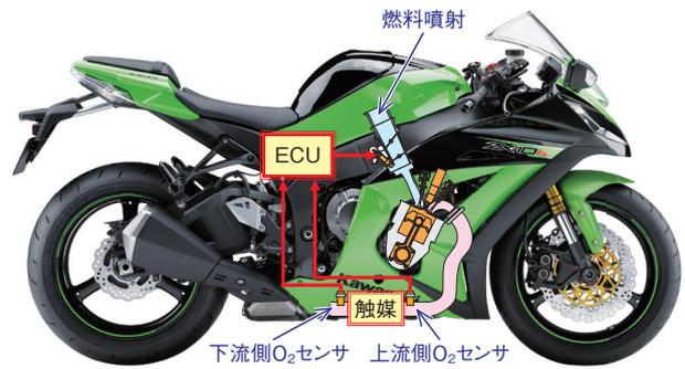
図7 デュアルO<sub>2</sub>フィードバックシステム
