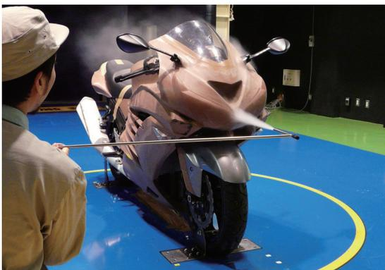
図12 風洞試験状況
