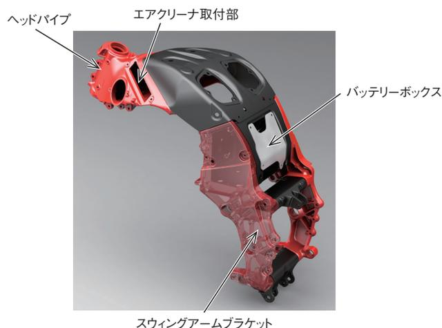
図10 アルミニウムモノコックフレームの変更部
