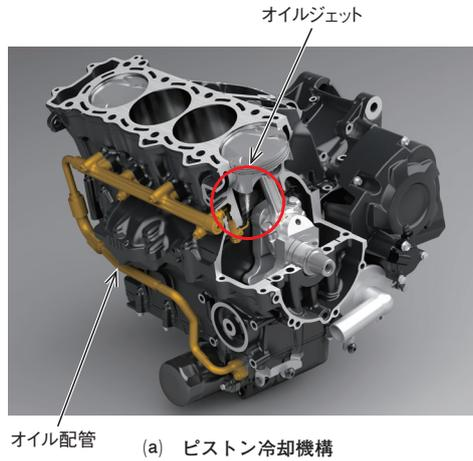
オイル配管 (a) ピストン冷却機構
