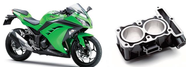
図6 スリーブレスシリンダを搭載した「Ninja 300」
