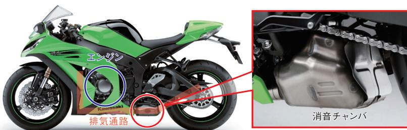
図1 本技術を搭載したモーターサイクル（ZX-10R）および消音チャンバ
