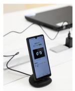
スタッフステーション・薬剤部・検査部に設置されたスマートフォンでFORROを所定の位置に呼び出したり、配送状況を確認したり、到着時の通知を受けたりすることができます。こちらも FORRO本体のタッチパネル操作同様、シンプルなユーザーインターフェースで直観的な操作が可能です。
