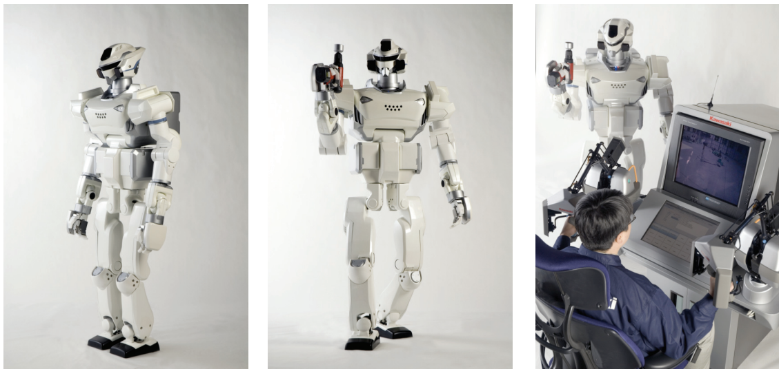
写真:人間型ロボットHRP-3(左及び中央)と遠隔操作装置(右)
