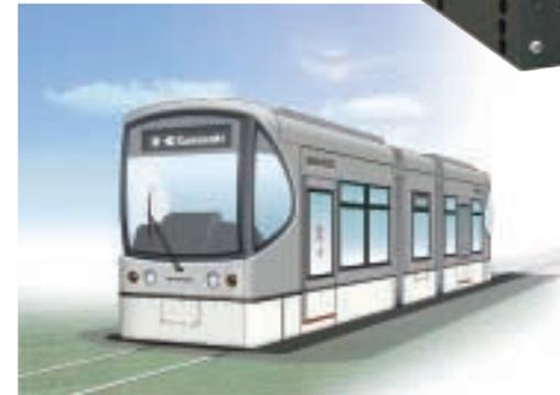
[写真上] 架線不要のLRV(低床電池駆動路面電車)「SWIMO(スイモ)」(開発中)
