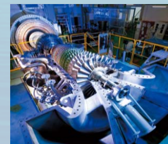
水素ガスタービン
