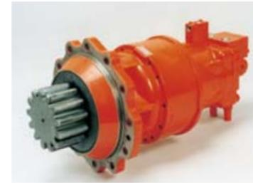
1. 建設機械用の旋回モータとして開発した、斜板形ピストンモータで、メカブレーキ、リリーフバルブ、メイクアップバルブを内蔵しています。
