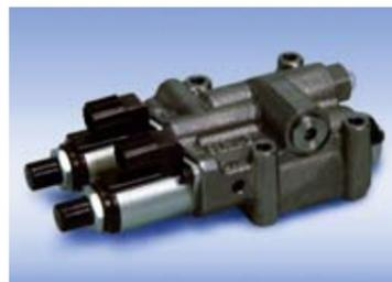
この電磁比例コントロール弁は、アクチュエータの作動圧に関係なく、行き側、戻り側の流量をソレノイドへの入力電流によって自由にコントロールすることができます。
