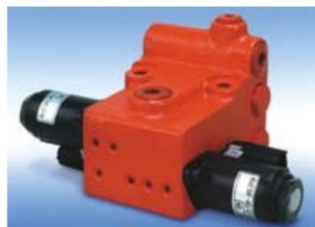
1. フローディバイダ [KFDZ] は、シーケンス弁を内蔵しているため、主回路の圧力がアンロードしたときでも、分流側に必要な流量を供給することができます。
