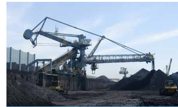
大手鉄鋼メーカー向けに製造されたスタッカ・リクレーマ ・払出能力 700t/時 ・積付能力 2,000t/時 ・全長:70m(うちブーム長40m)
