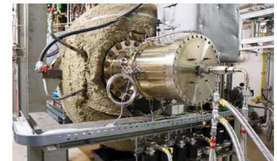
ドイツ アーヘン工科大学 高温/高圧燃焼試験設備での水素燃焼試験
