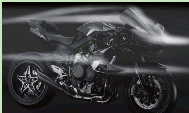
流体力学を味方に付けた 超高速型アップカウル
