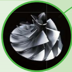
エンジン設計者がインペラまで設計したスーパーチャージャー
