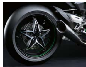
新開発された星形ホイール 最先端の強度解析技術によって新開発された、星形5本スポークタイプのアルミキャストホイールをリヤに採用。
