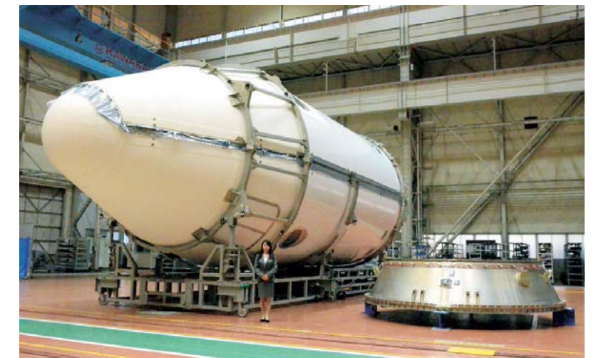
*:国際宇宙ステーションに補給物資を運ぶ手段として日本が開発した無人宇宙船。
