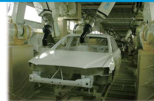
防爆塗装ロボットは、自動車工場の製造ラインに欠かせない装置となっている。(写真提供/マツダ(株))
