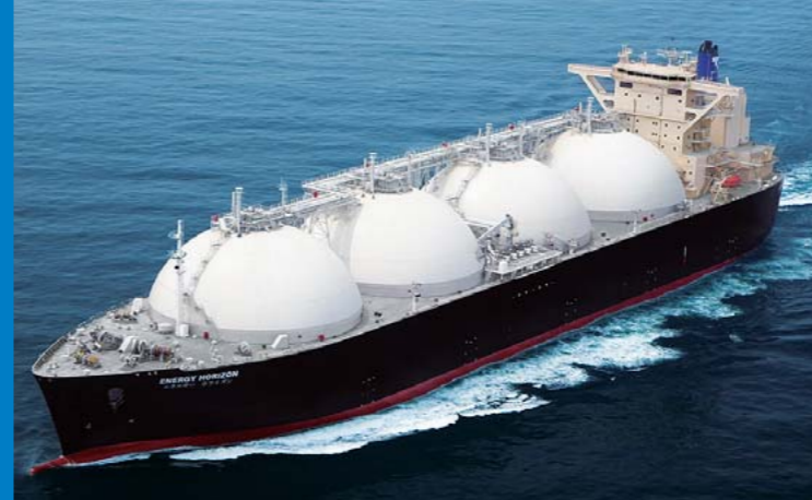
●イラストのモデルの次世代汎用型LNG運搬船「エネルギーホライズン」は、全長約300m、幅52.00m、計画喫水/満載喫水11.5m/11.9mである。
