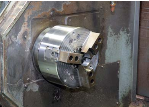
旋盤のチャック。油圧の力で“3本爪”が被切削物(ワーク)をつかんで固定する。
