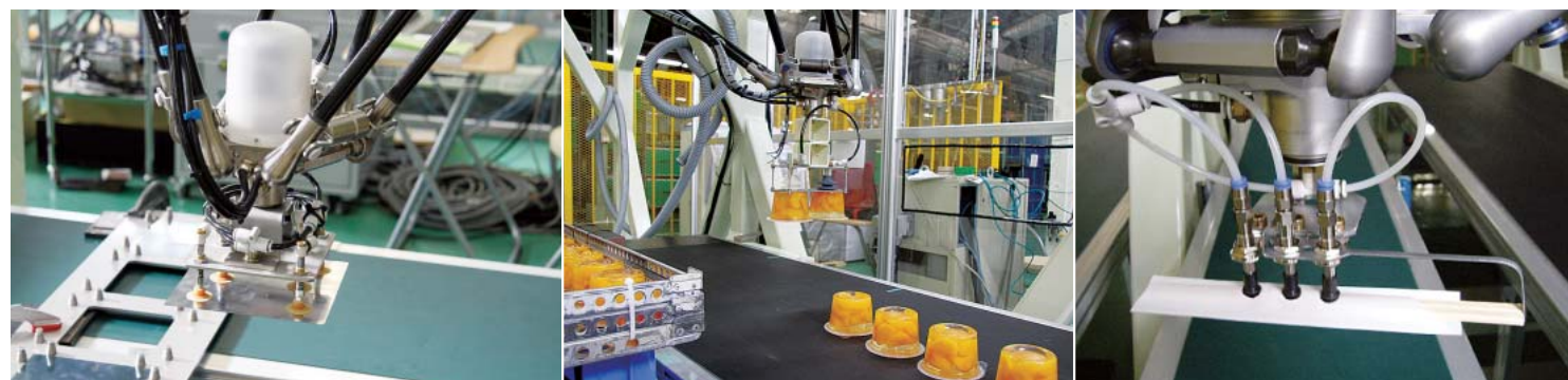
ピッキングの対象物は太陽電池のパネル（左）、容器入り食品（オレンジゼリー、中）、袋入り割箸（右）など大小、硬軟を問わない。
