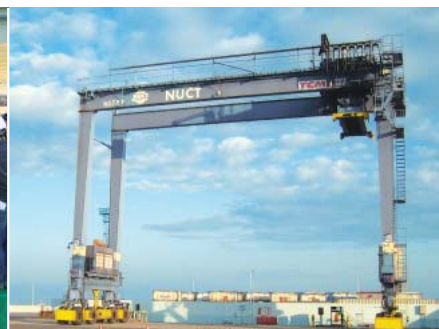
「ギガセル」の活用でトランスファークレーンでも回生電力を有効利用できる。
