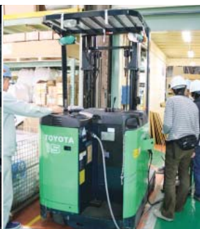
高速充電で稼働時間を延ばせるバッテリーフォーク。
