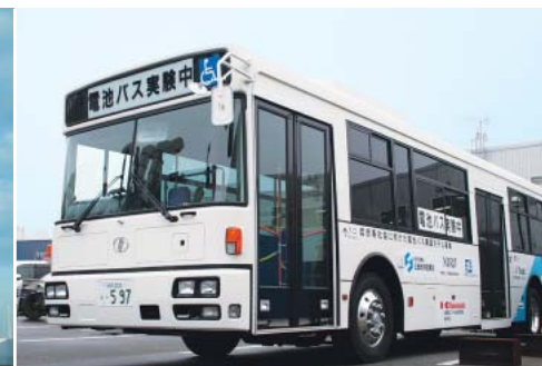
「ギガセル」を搭載した国内初の電池駆動大型バス。大阪市内で路線バスとして実証実験中。
