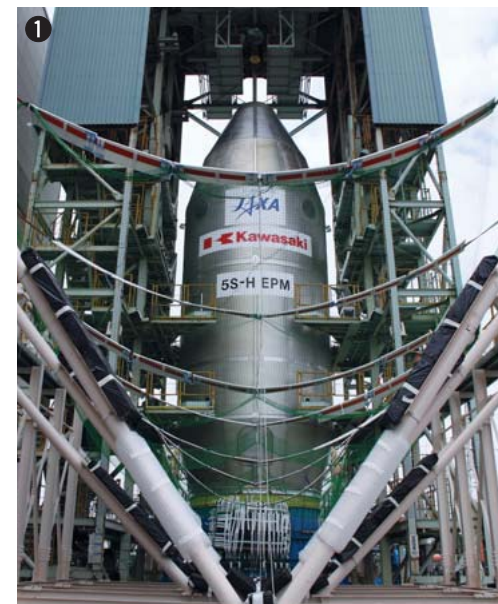
①試験設備にセットされた「HTV」専用の「5S-H」型フェアリング。 ②起爆と同時にバンという大きな音を発して「5S-H」型フェアリングが二つに割れた瞬間。9月11日未明の「H-IIB」ロケットの打ち上げでも、宇宙の彼方で計画通りに分離放てきされた。 ③川崎重工・播磨工場での分離放てき試験は報道陣が見守る前で行なわれ見事に成功した。
