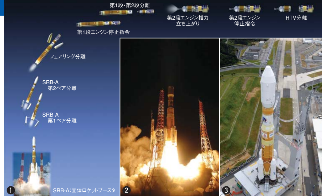
①9月11日に打ち上げられた「H-IIB」ロケットの動き。フェアリングは打ち上げから約220秒後、正常に分離放てきされた。そして9月18日、「HTV」は計画通りISSとのドッキングに成功した。②その打ち上げの瞬間。③「H-IIB」ロケットの先端に設置された「5S-H」型フェアリング。(図版・写真提供/JAXA)
