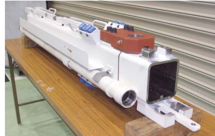
川崎重工が開発したインナー装置。塩化ビニール管の内部にセットされ、元押しジャッキからの推力を伝えて管を押ししていく。
