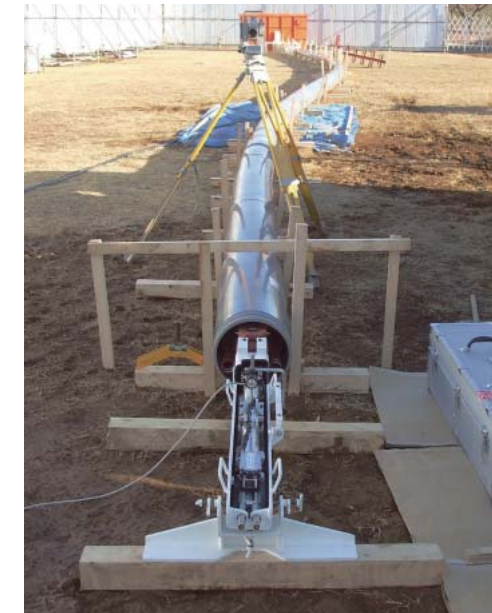
↑川崎重工が開発した、高性能小型ジャイロ搭載の超小型自走式計測ロボット。この計測ロボットの開発が正確な長距離・曲線推進を実現した。 ←実証実験に先立って行なわれた地上実験風景。
