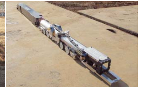
↑川崎重工が開発した、高性能小型ジャイロ搭載の超小型自走式計測ロボット。この計測ロボットの開発が正確な長距離・曲線推進を実現した。 ←実証実験に先立って行なわれた地上実験風景。
