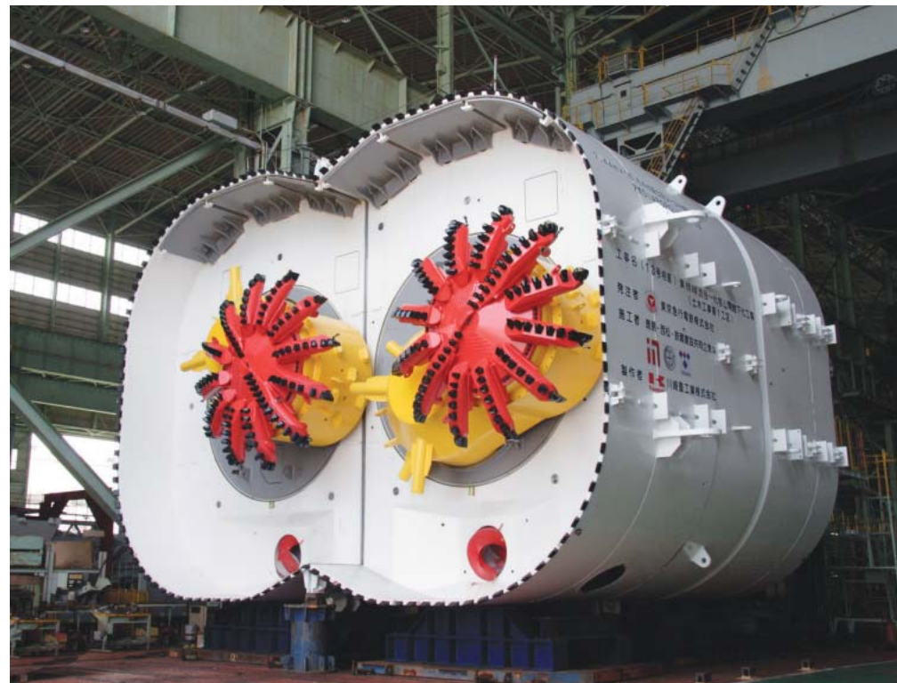
完成した2連型の「アポロカッター工法シールド掘進機」。高さが7.44mで幅は10.64m。
