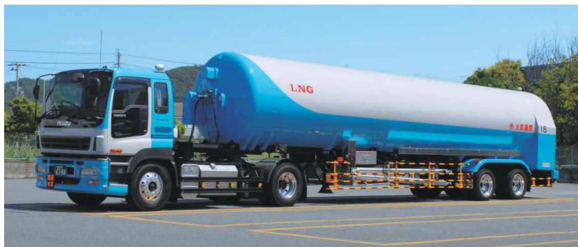
実用化されて活躍中の大阪ガス（株）向け14tクラスの大型LNGタンクトレーラ。
