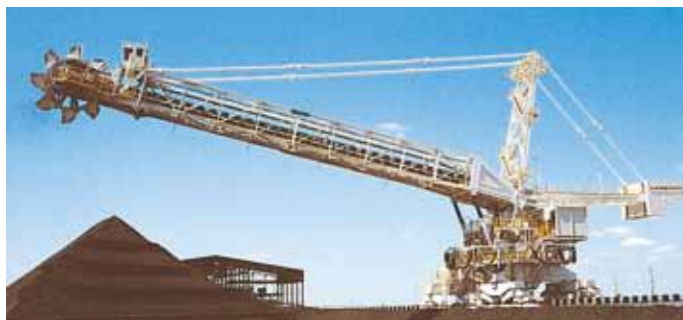
3,300T/Hリクレーマ ヤードに積付けられた石炭・鉄鉱石などのバラ物を、バケットホイールによって連続的に掘削、ヤードコンベヤに払出します。
