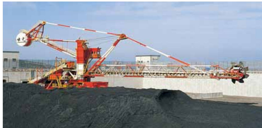
3,000/2,400T/H スタッカ・リクレーマ 積付け・払出しの両機能を有しています。
