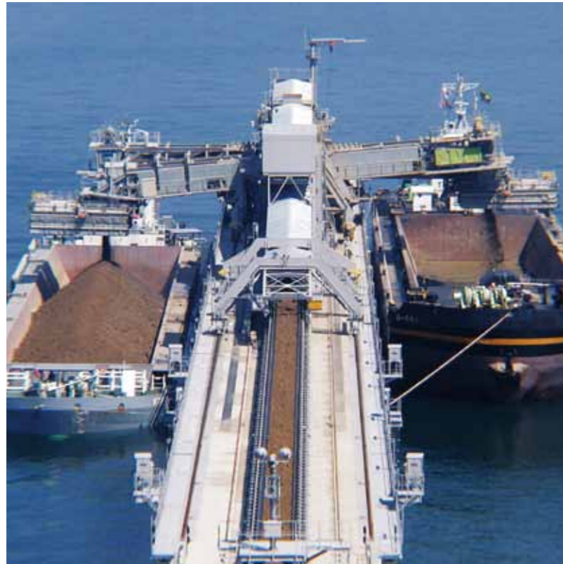
15,500T/Hシップローダ ベルトコンベヤなどで運ばれてきたパ ラ物を、連続的に運搬船に積載します。
