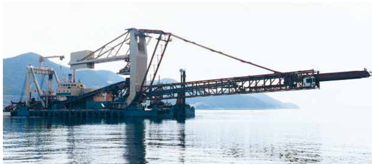
6,050T/Hスプレッダ ベルトコンベヤで運ばれてきた土砂等を連続的にまき出します。 まき出し範囲が広いので、大容量で効率のよい埋立てが行なえます。
