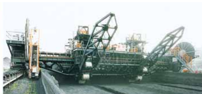
900T/Hリクレーマ ブリッジタイプのバケットホイール式リクレーマ。自動運転による払出しが可能で、ブレンディング積付けされたバラ物の払出しに最適です。
