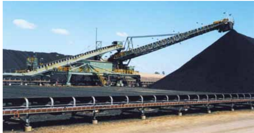
2,000T/Hスタッカ コンベヤで運ばれてきたバラ物をヤードに積付けます。
