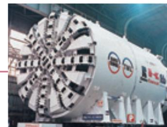
直径8.78米护盾式TBM
