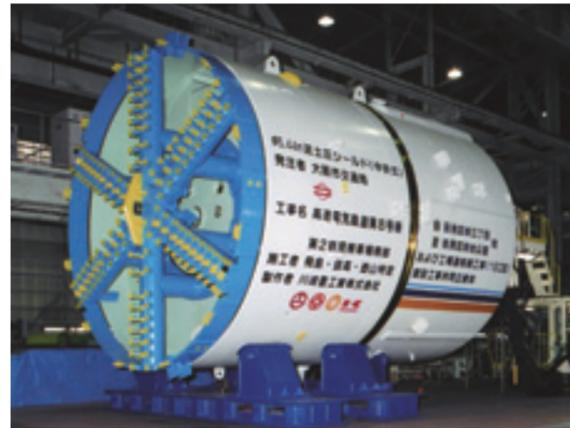
直径5.44米泥土压盾构机
