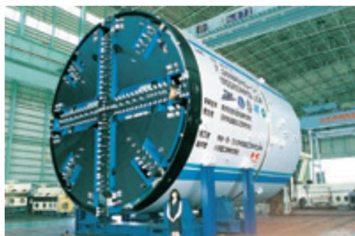
直径7.26米泥水MSD盾构机
