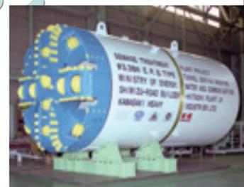
直径3.38米泥土压盾构机
