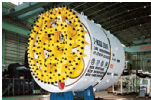
直径7.67米泥土压DPLEX盾构机
