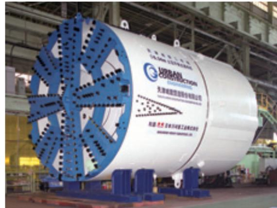
直径6.34米泥土压盾构机
