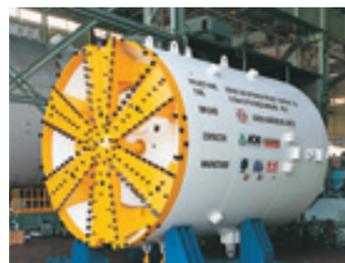
直径5.03米泥土压盾构机
