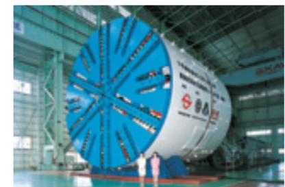
直径10.04米复线盾构机（侧面盾构卸除后）
