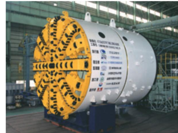
直径7.93米泥土压盾构机
