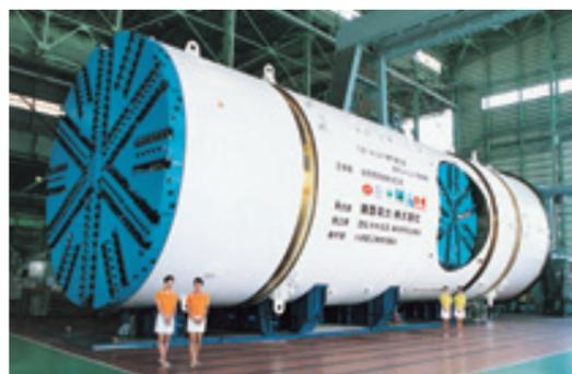
直径7.26米/直径4.24米泥水直角分岔型盾构机
