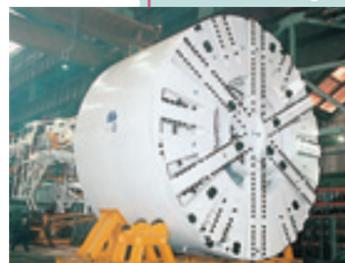
直径9.74米泥土压盾构机
