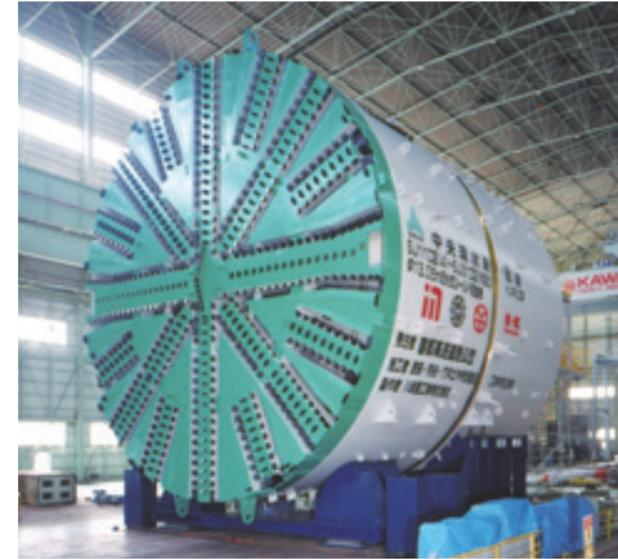
直径13.05米泥水盾构机（装备有刀具更换装置\*）
