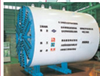
直径6.24米泥土压盾构机
