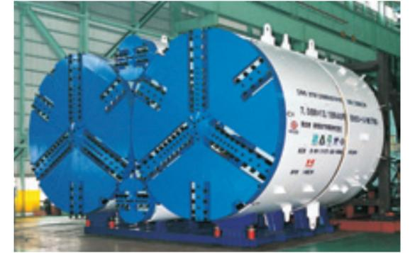
7.06米×13.18米四心圆泥水盾构机
