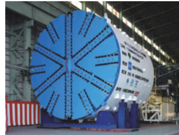
直径10.0米泥水盾构机
