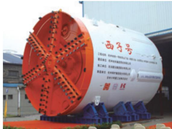
直径6.34米泥土压盾构机
