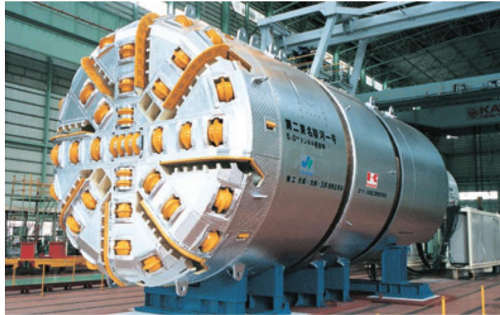
直径5米护盾式TBM（皮带输送机排土方式 对应R=30米）
