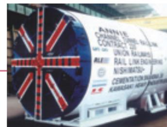
直径8.11米泥土压盾构机(双模)
