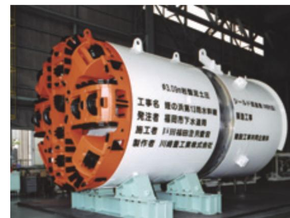
直径3.09米硬岩泥土压盾构机
