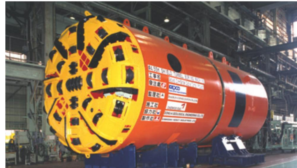
直径4.55米护盾式TBM（皮带输送机/螺旋输送管排土方式）
