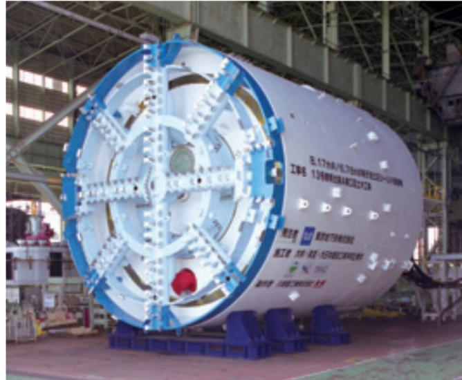
直径8.17米/直径6.78米母子型泥土压盾构机
