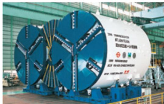
直径7.44米/直径16.44米泥水三圆盾构机
