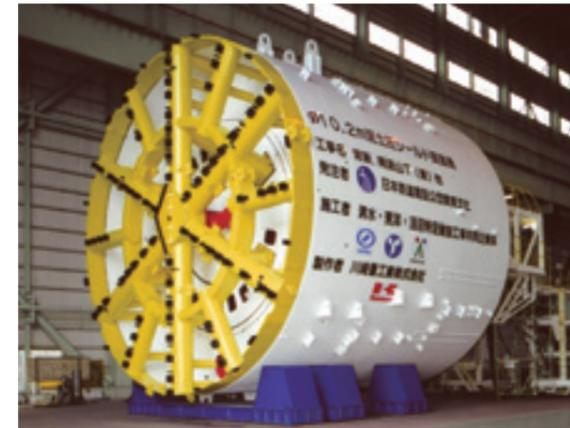
直径10.2米泥土压盾构机
