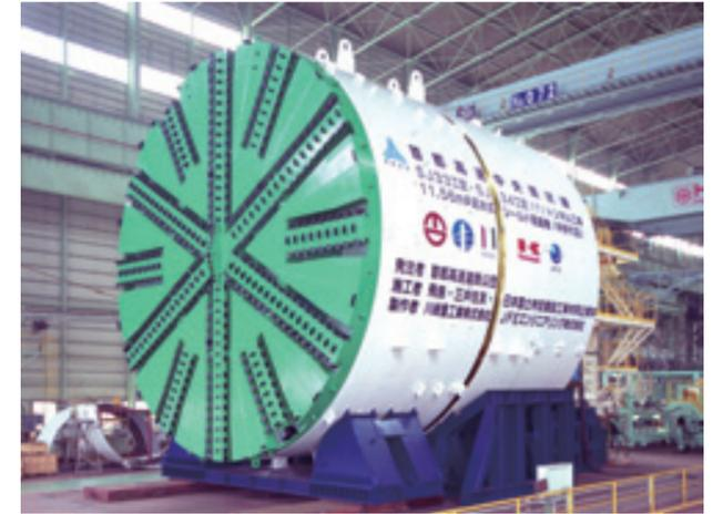
直径11.56米泥水盾构机
