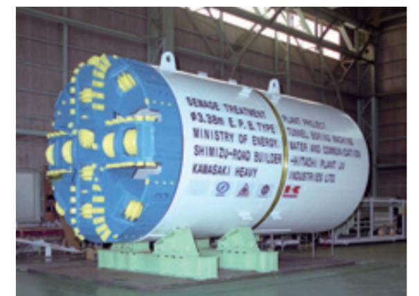
直径3.38米泥土压盾构机
