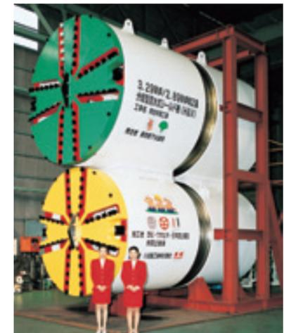
直径3.29米/直径2.89米纵双圆分岔型H&V盾构机
