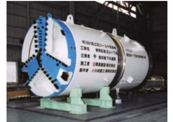
直径2.88米泥土压盾构机（对应R=10米）
