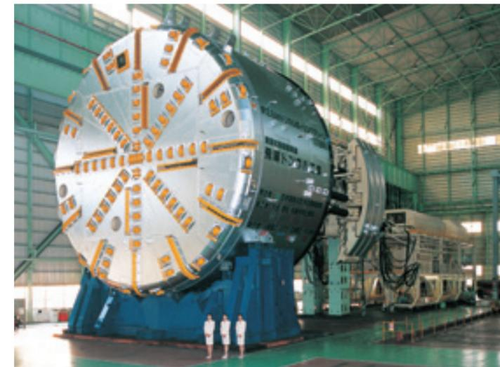
直径12.84米改良开敞式TBM
