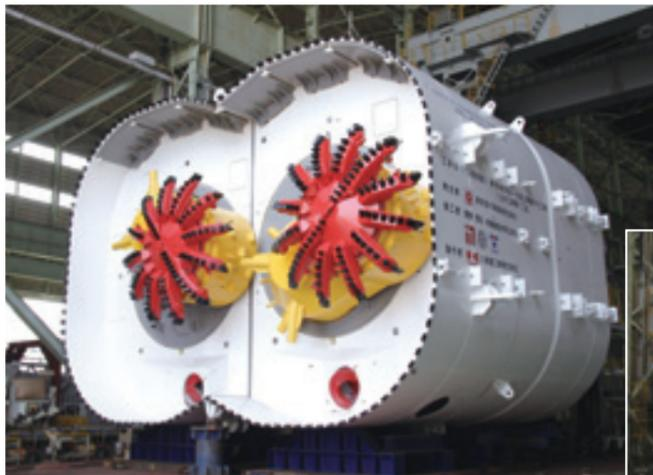
7.44米×10.64米泥土压盾构机
