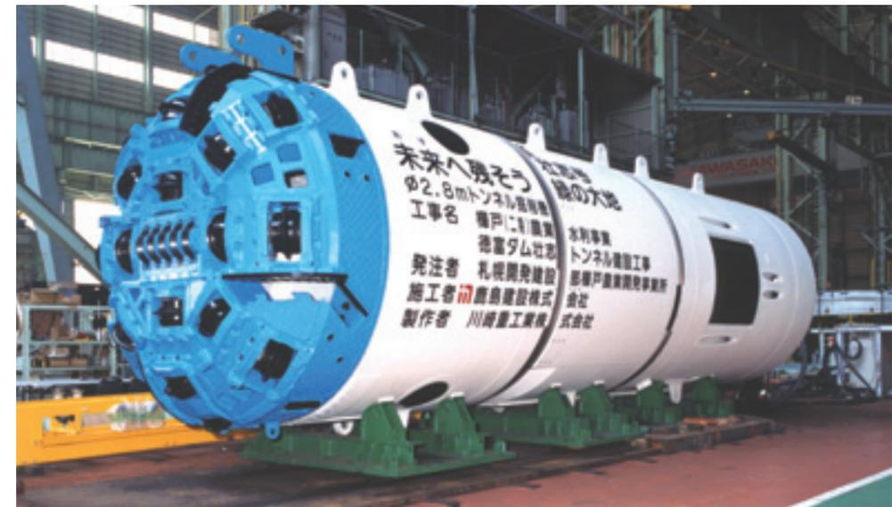
直径2.8米护盾式TBM（皮带输送机排土方式）
