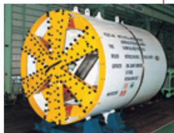
直径6.43米泥土压盾构机(双模)
