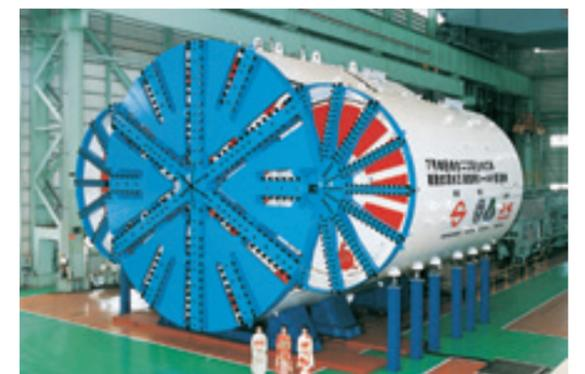
直径10.04米×15.84米三圆盾构机（装有侧面盾构机时）
