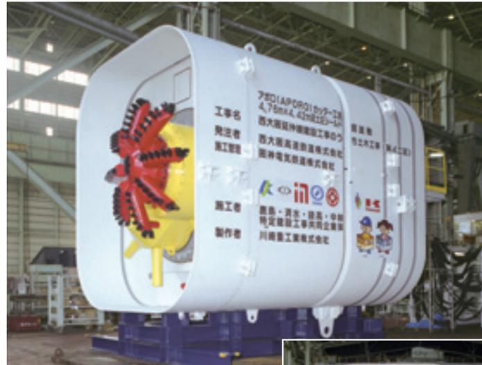
4.76米×4.42米泥土压盾构机
