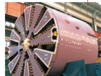
直径6.34米泥土压盾构机
