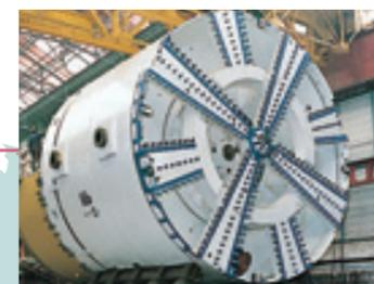
直径7.65米泥土压盾构机
