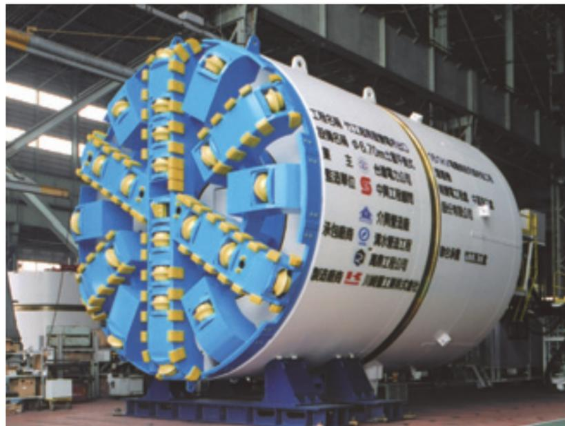
直径6.70米泥土压盾构机
