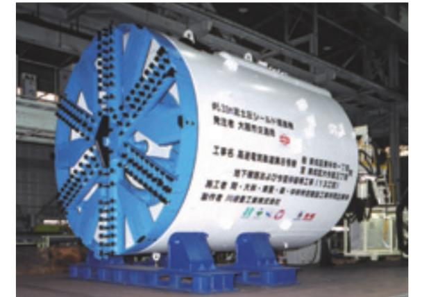
直径5.33米泥土压盾构机
