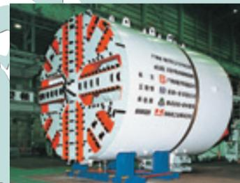
直径6.14米泥土压盾构机
