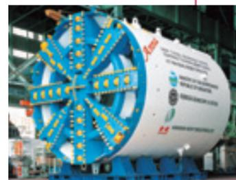
直径7.16米泥土压盾构机(双模)
