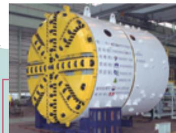
直径8.80米泥水盾构机
