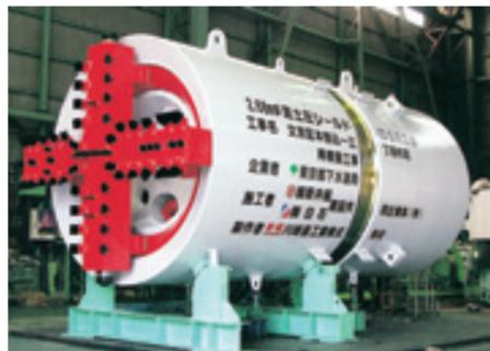
直径2.68米泥土压盾构机(DSR施工法)
