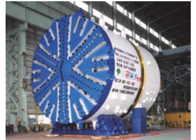
直径8.99米泥水盾构机（装备有刀具更换装置\* R=30米对应）
