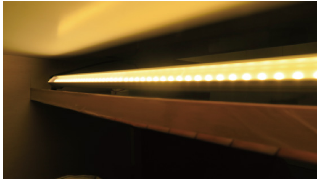
側天井間接照明の照射角度検証
