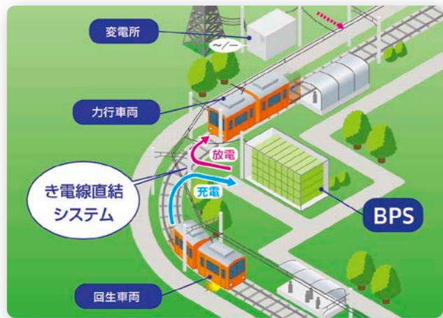
地上蓄電設備 (BPS)
