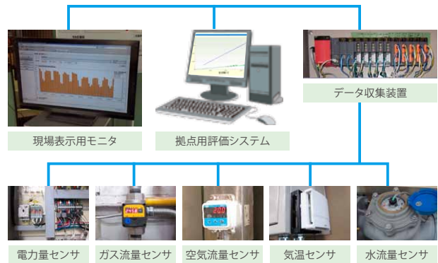
エネルギー見える化設備構成
