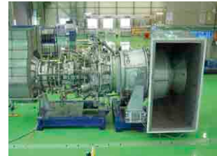
「L30A」ガスタービン
