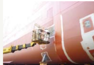
高所作業車を使った船舶の溶接検査
