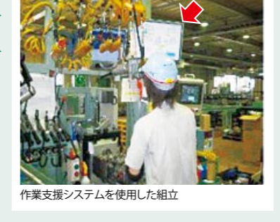
作業支援システムを使用した組立
