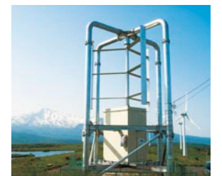
日本飛行機(株)が開発したどの方向からの風でも発電できる縦軸型風力発電装置
