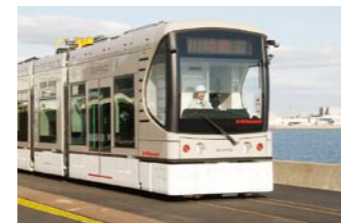
【超低床電池駆動路面電車(LRV)「SWIMO」】
