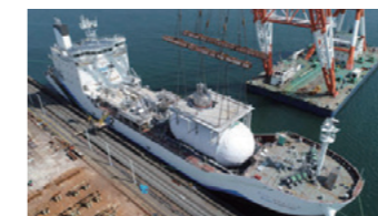
海上輸送用液化水素タンクの搭載の様子
