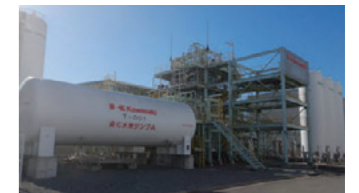
新型液化機を組み込んだ液化システム
