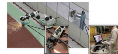
Successor®-Gを用いた研削工程
