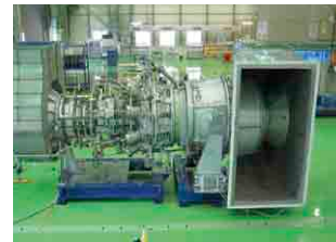
「L30A」ガスタービン
