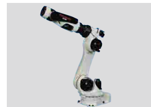
スポット溶接用ロボット「BXシリーズ」
