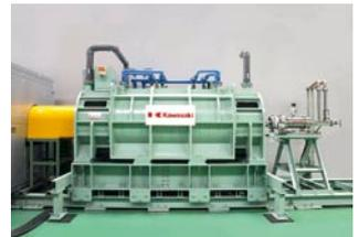
超電導モータ試作機
