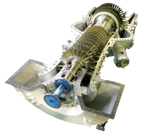
M7A-03ガスタービンの内部
