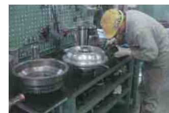
リビルドで再生中のトランスミッション
