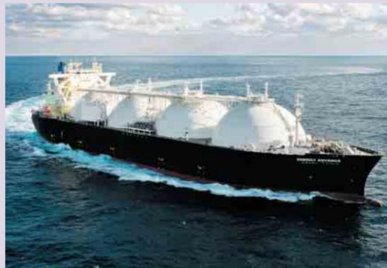
14万5千m<sup>3</sup>のLNGを積んで航行中のLNG運搬船「エネルギーアドバンス」
