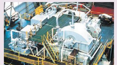
LNG運搬船用蒸気タービン
