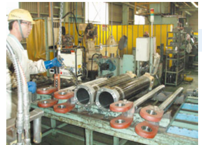
ニアネットシェイブによってつくられたホイストシリンダ
