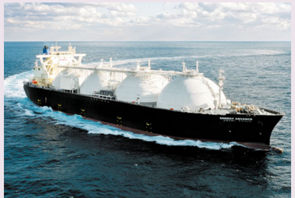
14万5千m 3 のLNGを積んで航行中のLNG運搬船「エネルギーアドバンス」
