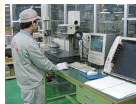
調達部品の形状測定検査
