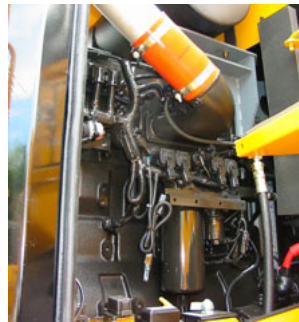
ターボチャージャー・インタークーラー搭載エンジン
