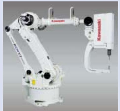
専用ガンと多関節ロボットを組み合わせたシステム例
