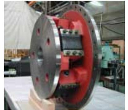
新開発のKC継手(圧縮型高弾性ゴム継手)
