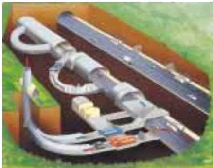
トンネル内のバイパス風路や外部への放風路に設置された電気集塵設備
