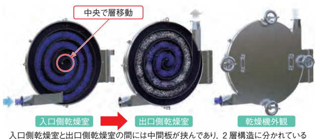
図2 連続乾燥部の構造 Fig. 2 Structure of continuous drying unit
